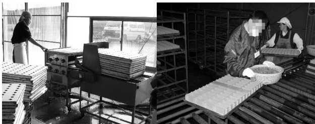
写真4 パネル洗浄(機械) (側面は手作業で洗う)
