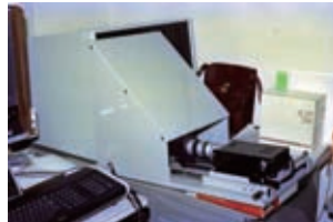
図3 WPD-1 の外部カメラ: ミラーを活用して PC 等のモニターを撮影する。
