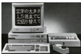
図5 PC-WIDE:PC 本体とモニター間に接続して文字サイズや文字色を変更する装置。拡大画面の移動は、カーソルの自動追従またはジョイスティックによる。
