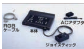
図6 PC-WIDE II : PC-WIDE の後継機。幾分小型軽量となり、表示色等が増え、価格も低下した。
