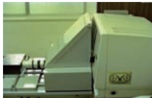
図2 WPD-1 のフード部分: ワープロ専用機のモニター(右)に接合されている。
