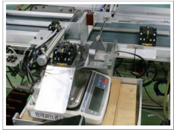
ナット過剰自動検査装置
