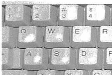
図3 「かなタイプシート」の拡大写真 (画像処理により「かな」の部分を消した)
