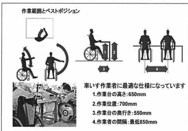
図1 作業範囲とベストポジション
