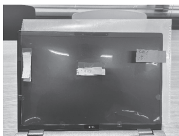
図1 PCのモニターに設置した「ミス防止治具」
