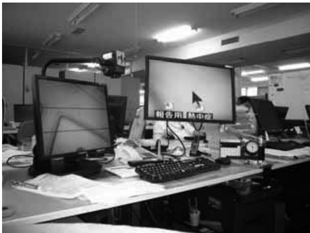
図 3-8 アクロバット LCD の利用状況(カメラを回転させれば遠方のホワイトボードも拡大表示できる)
