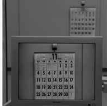
図 3-3 フリーアームを活用した省スペース拡大読書器の試作器（左はキーボードと資料を操作しやすいようにカメラを右にスライドさせ状態、右はカメラを後方に向け壁のカレンダーを拡大表示した状態）
