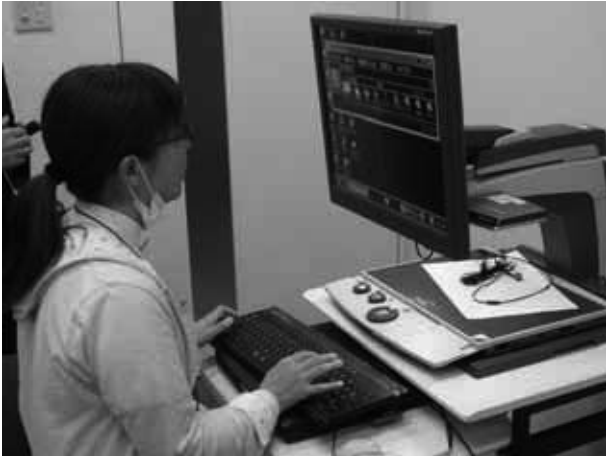
図3-5 拡大読書器とパソコンの画面兼用の例（デスクトップ型拡大読書器クリアビュープラスの画面に、ノートパソコンの画面も表示でき、手元スイッチで画面を切り替える。パソコンはデスク左奥に蓋を閉じた状態で配置。）
