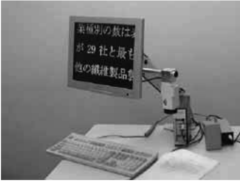
図 3-3 フリーアームを活用した省スペース拡大読書器の試作器（左はキーボードと資料を操作しやすいようにカメラを右にスライドさせ状態、右はカメラを後方に向け壁のカレンダーを拡大表示した状態）
