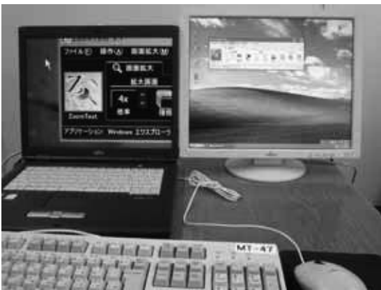
図2-1 デュアルモニターの「プライマリ1倍表示」機能（ノートパソコンのモニターがプライマリモニターで拡大白黒反転表示、右の外付けモニターがセカンダリモニターで通常画面表示）。ここでは操作性に配慮して、外付けのフルキーボードとマウスを利用している。
