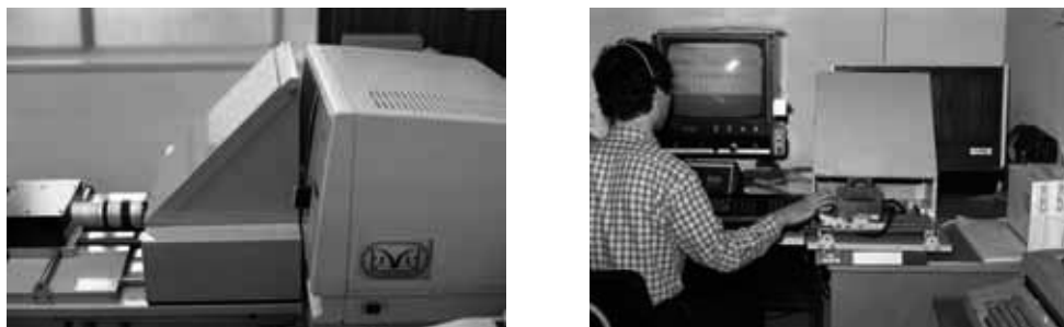
付図4 WPD-1（左はモニター画面を覆うフード部分、右はメディカル・トランススクライバーの作業風景）
