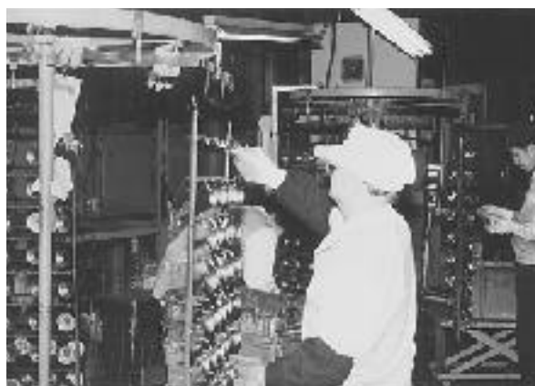
治具の掛け外し作業
