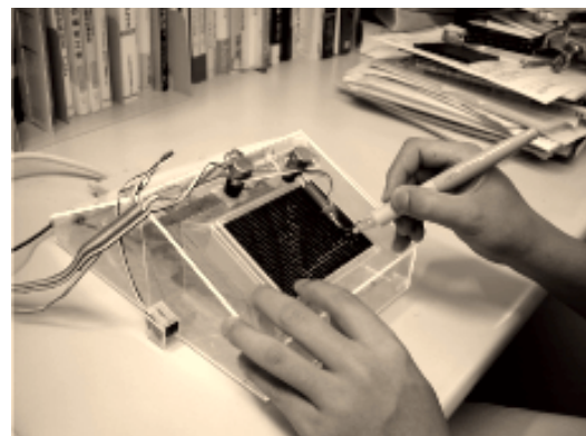
図4-3-3 可動アームに取り付けたペンで描画している様子
