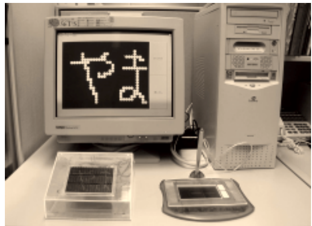
図4-2-2 2次元触覚ディスプレイシステム第1次試作の外観
