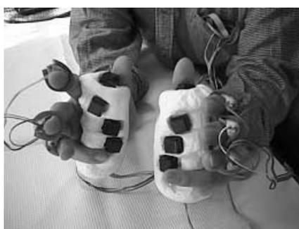
図2-14(a) 携帯型装置用グリップ式入力用点字キーボードと振動子を装着した状態
