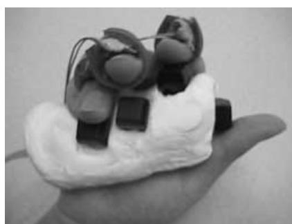
図2-14(b) 振動モーターを装着し、入力用点字キーボードを握っている写真(右手側)
