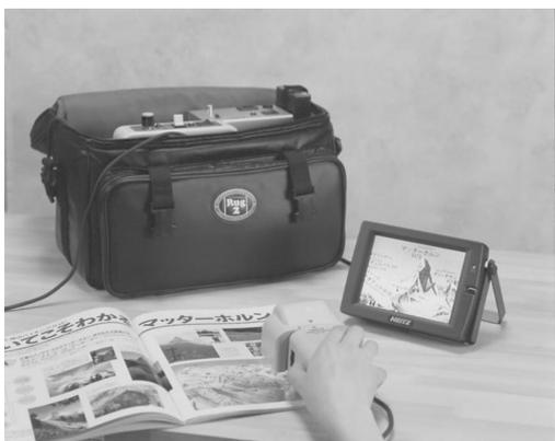
図 1-4 携帯型拡大読書器の例（ナイツ社製 VS-5-TK）
