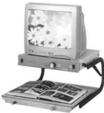
図 1-2 据え置き・縦配置・モニター分離型拡大読書器の例（ミカミ社製TOP-AF1）
